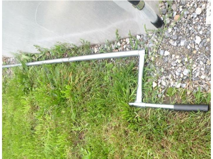
Die Kurbel (Pos. 9) wird mit vormontierter Schraubenverbindung (Pos. 9.1 – 9.2) für das Rollrohr geliefert. Bitte lösen und diese Verbindung für die Montage verwenden.
